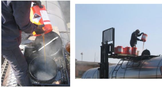
Figura 8 Aplicação do Aditivo diretamente ao ligante, previamente ao processo de mistura.
